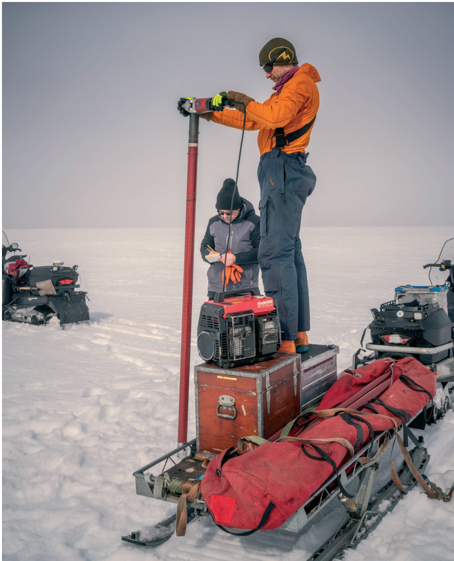
Við jöklarannsóknir á Hofsjökli. Borað ofan í jökulinn til að ná í borkjarnasýni til að meta afkomu jökulsins, hvort að hann sé að rýrna eða vaxa. Oft er talað um jökla sem lifandi kennslustofu í loftslagsbreytingum þar sem áhrif breytinganna eru mjög sýnileg á jöklum landsins. Ljósmynd: Valdimar Leifsson.
